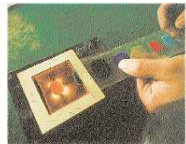
MIT HILFE EINER POLARISATIONSFOLIE werden Spannungen im Glas sichtbar. Die Nebel verraten, dass die verschmolzenen Gläser nicht die gleichen Ausdehnungseigenschaften hatten und somit fürs Fusing ungeeignet sind.
