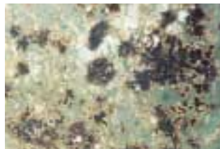
Durch Korrosion geschädigtes Glas unter dem Mikroskop
